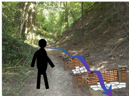
Profil de talweg en "V" avec banquettes Maintien des accès par contournement latéral Aménagement prioritaire des micro-barrages
